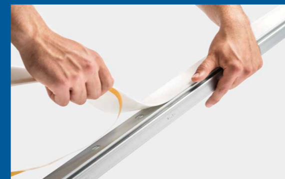
↑ Binario per l'ancoraggio del sistema Geberit Duofix al soffitto e al pavimento. Applicare il nastro disaccoppiante all'elemento e fissare i binari al pavimento e al soffitto.
